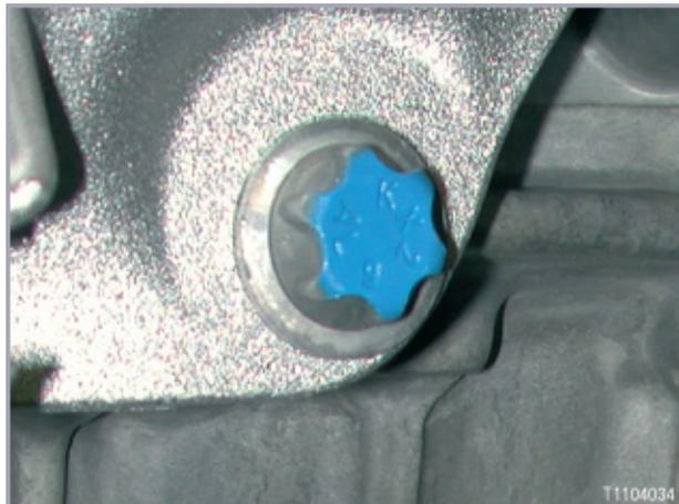
Aluminiumschrauben sind mit blauen Schraubenköpfen gekennzeichnet. Aluminiumschrauben dürfen grundsätzlich nur 1-mal verwendet werden. Die Schrauben sind somit nach jedem Lösen zu erneuern.
