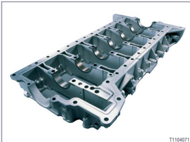
Am N52 kommt ein geteiltes Kurbelgehäuse zum Einsatz. Das Oberteil besteht aus einer Magnesium-Aluminium-Verbundkonstruktion. Zur Erhöhung der Steifigkeit wurde das Unterteil als Bedplate konstruiert. Diese Bedplate besteht ebenfalls aus Magnesium. Zur Aufnahme der Hauptlagerkräfte werden Einsätze aus Sinterstahl verwendet.
