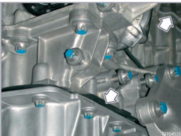
Kontaktkorrosion zwischen den Metallen lässt sich durch eine nicht leitende Dichtung verhindern. Die Ölwanne- und die Zylinderkopfdichtung sind nicht leitend. Die Dichtungen trennen die Ölwanne und den Zylinderkopf aus Aluminium vom Kurbelgehäuse aus Magnesium.
